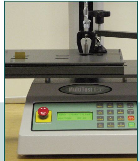
Wedge grip shown gripping flexi-circuit
